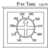
为防止电机长时间超功率运行从而损坏电机请按照左图所示数值结合所配电机功率进行正确设定。当负载发生较大变化导致电机实际运行功率超过设定值时驱动器将进入自动保护模式。
