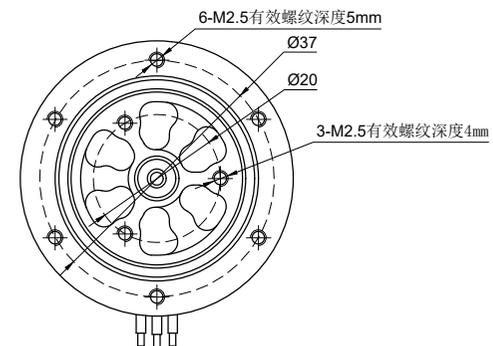
前盖的作用为约束轴承，无前盖状态适用于电机安装位可以约束轴承的情况，用以减小安装高度。
